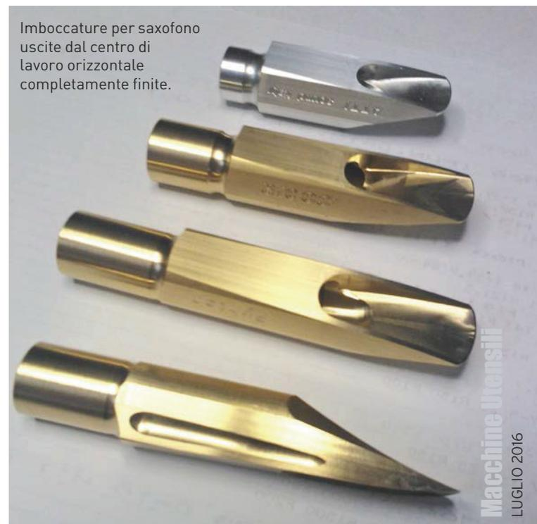
Imboccature per saxofono uscite dal centro di lavoro orizzontale completamente finite.
